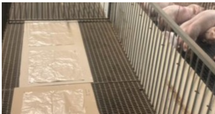
Collecte des aérosols (poussières) sur des feuilles d'aluminium
